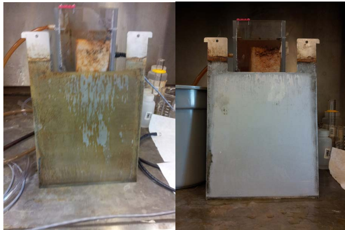
Figure 2. À gauche, une électrode « encrassée; à droite, la plaque après deux minutes de traitement aux ultrasons
